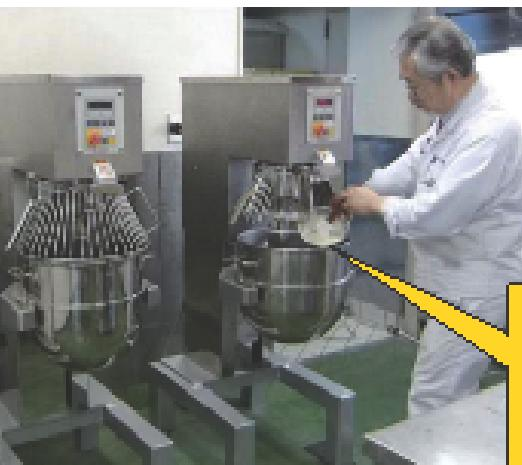
インターロック装置(可動式扉を開けないと機械が動かない機械)を有するミキサーの事例
