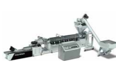
カッター一体型高速ペレット化設備
